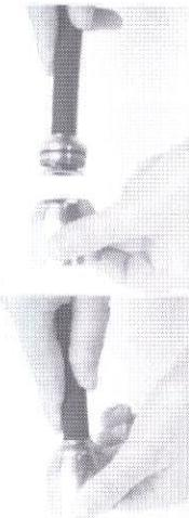
1.) Csavarja le a megvilágító gyűrűt a kameráról! Ellenőrizze a 25x1,5 O-gyűrűt a kamera oldalán, és addott esetben cserélje ki új, zsírral kent O-gyűrűre!
